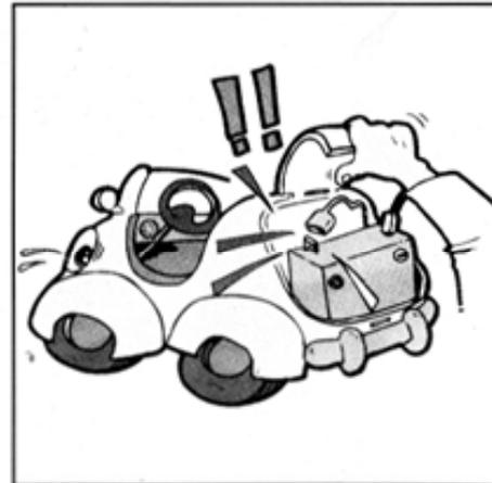
Controllare l'impianto elettrico del veicolo a intervalli regolari. Prestare attenzione ai danni ai cavi e connettori. Controllare se le batterie sedere impresa. Se si nota la presenza di irregolarità, non utilizzare il veicolo fino a quando il problema è stato risolto da un esperto.
