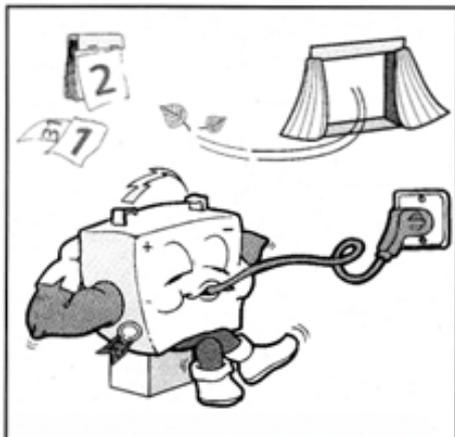
Se il veicolo non sta per essere utilizzato per un lungo tempo, prima caricare la batteria, e quindi scollegare il connettore della batteria dal veicolo. La batteria dovrebbe essere ricaricata almeno ogni 2 mesi.
