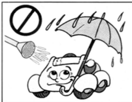
Veicolo, connettori, motore e batteria proteggere contro l'umidità. Non spruzzare mai veicolo con un tubo dell'acqua.
