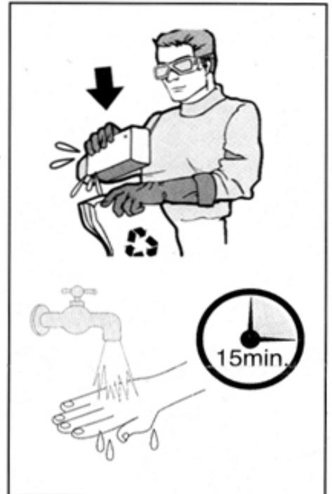
SOLLTE DER AKKU UNDICHT WERDEN ENTFERNEN SIE ES UNTER VERMEIDUNG JEDLICHEN HAUT- UND AUGENKONTAKTES MIT DER AUSTRETENDEN FLÜSSIGKEIT AUS DEM FAHRZEUG UND PACKEN SIE ES IN EINEN PLASTIKBEUTEL. WIE SIE DEN AKKU ENTSORGEN KÖNNEN ENTFERNEN SIE BITTE DER BEDIENUNGSANLEITUNG.
