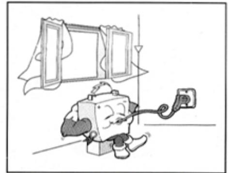
WÄHREND DES LADEVORGANGES KÖNNEN EXPLOSIVE GASE ENTSTEHEN. LADEN SIE DIE AKKUS DESHALB NUR IN GUT DURCHLÜFTETEN RÄUMEN UND FERNAB VON LEICHT ENTFLAMMBAREN MATERIALIEN.
