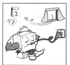
IF THE VEHICLE WON'T BE OPERATED FOR A LONG TIME, CHARGE THE BATTERIES AND DISCONNECT THE BATTERY PLUG FROM THE VEHICLE. THEN, THE BATTERIES MUST BE CHARGED ONCE TWO MONTHS AT THE LATEST, IF YOU WON'T USE IT IN THE MEANTIME.
